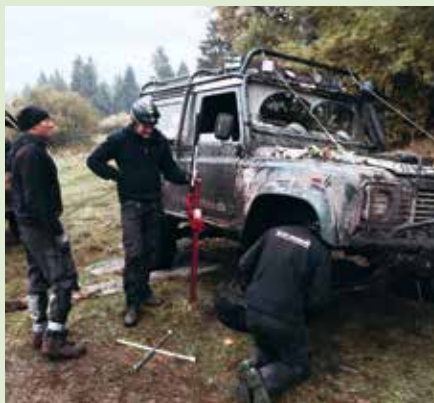
Vi skruer igen på Jakobs bil. En sten har kilet sig fast i caliperen. Pomerania 38 (fotograf: Mads Bak Petersen #5391, reg. nsj)
