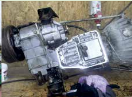
Det er jo nemt at lave stort service, når ZF7HP22-automatgearkassen ligger på filebænken. Værkstedet i Lundby (fotograf: Rasmus Olsen #7261, reg. ssj)
