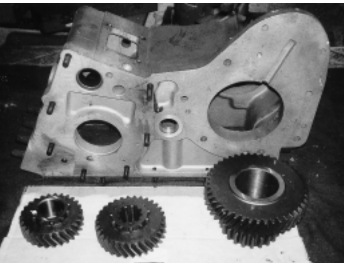
Transfer gearkassen fra Ian Ashcroft, som har givet Bo lavere omdrejninger og samtidig mindre støj.
