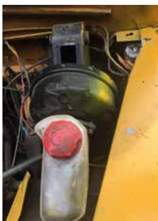
VENSTRE Koblingskonsol gemt bag bremsen under skærmen. MIDTEN Bremsehovedcylinderen løsnet. HØJRE Husk slangen til vacuumforstærkeren.
