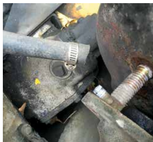
VENSTRE Koblingskonsol gemt bag bremsen under skærmen. MIDTEN Bremsehovedcylinderen løsnet. HØJRE Husk slangen til vacuumforstærkeren.
