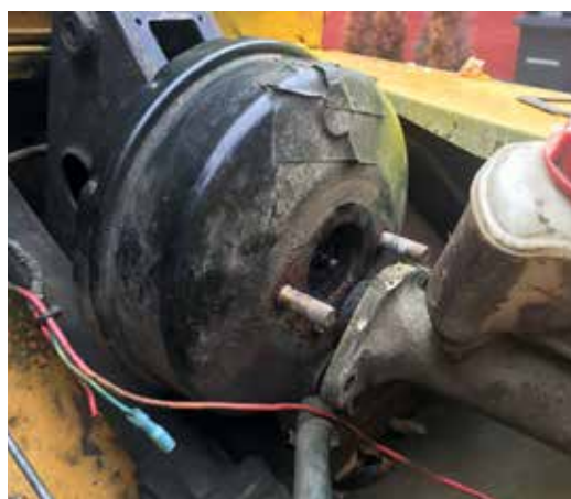
VENSTRE Koblingskonsol gemt bag bremsen under skærmen. MIDTEN Bremsehovedcylinderen løsnet. HØJRE Husk slangen til vacuumforstærkeren.
